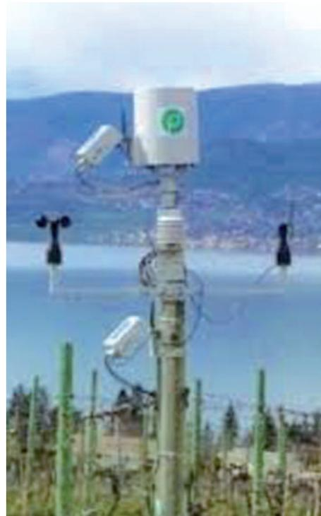
Equipo de control de humedad y temperatura del suelo
