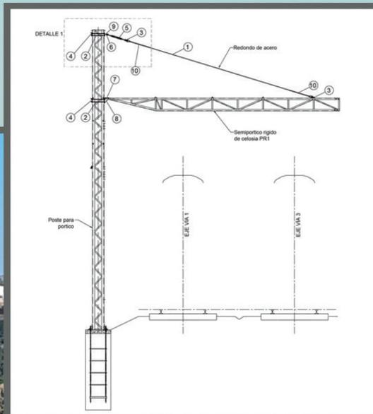
La imagen superior, tomada del proyecto constructivo de la electrificación de la línea entre Teruel y Zaragoza, muestra la correcta disposición de los postes de la catenaria para dar servicio a una doble vía. En el caso de la fotografía de la derecha, el poste se ha colocado en el lugar incorrecto.
